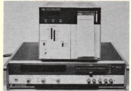
Afb. 1. De DMM, model 3490A meet hier periodiek weerstanden, waarbij de data in serie bytes van 8 bits via de hoofdlijn naar de 5150A thermische printer wordt gestuurd. Deze laatste regelt de meettijd interval, bepaalt het meetstip en drukt dit af naast de meetwaarde.
