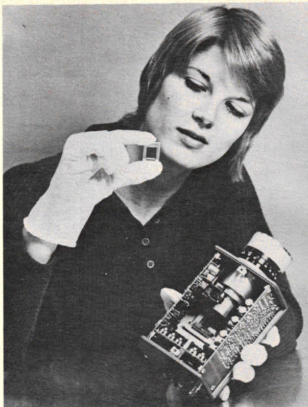
En medewerkster van RCA houdt de camera in haar linkerhand en de sensor in haar rechter. Beide komen tegen april 1975 ter beschikking van de Amerikaanse industrie, terwijl Europa begin 1976 deze noviteiten zal kunnen aanschaffen. De camera's „zonder opneembuis“ produceren standaard TV-beelden en zijn zeer geschikt voor bewakingsdoeleinden in industrie en leger-onderdelen. De sensor-chip (niet censorship!!) bevat 512 \times 320 = 163\ 840 elementen en heeft het formaat van een normale postzegel.
