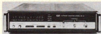
Afb. 7. Heterodyne teller van 10 Hz...18 GHz.
